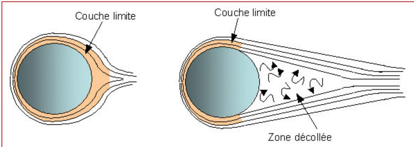
**S**econde composante de la traînée de forme, la traînée de pression est également une conséquence de la nature visqueuse des fluides, et du fait que cette viscosité provoque l'apparition d'une couche limite au voisinage de l'objet.
